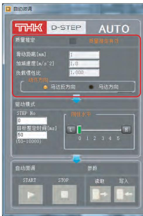
· 自动设定时，请确认显示的“滑动距离”、“加减速度”，选择“动作方向”。
