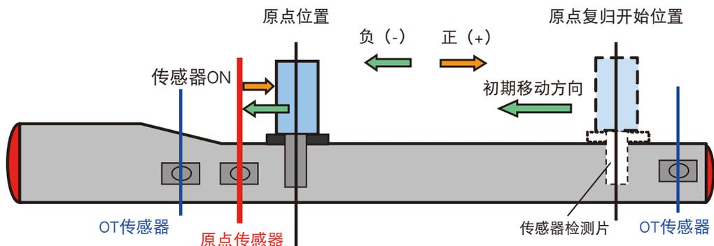
注)原点复归方向为电机相对侧时, 正(+)/负(-)与上图相反。
