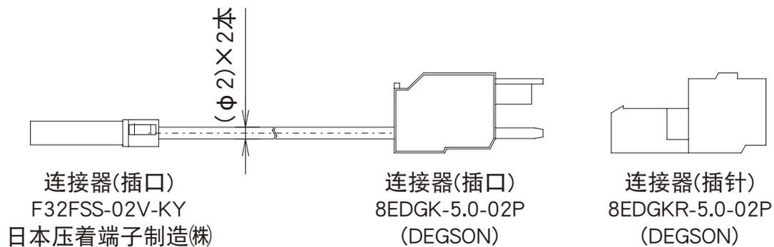
※附带电缆插入夹具(DG010-01P-19-00AH)。
