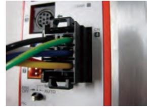
3. 请将编码器传感器连接器连接到THC的CN2上。
