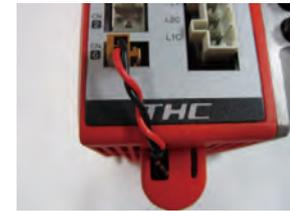
5. 请将再生电阻用连接器连接到THC的CN8上。
