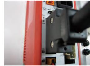
4. 请将电池连接器(褐色)连接到THC的CN6上。
