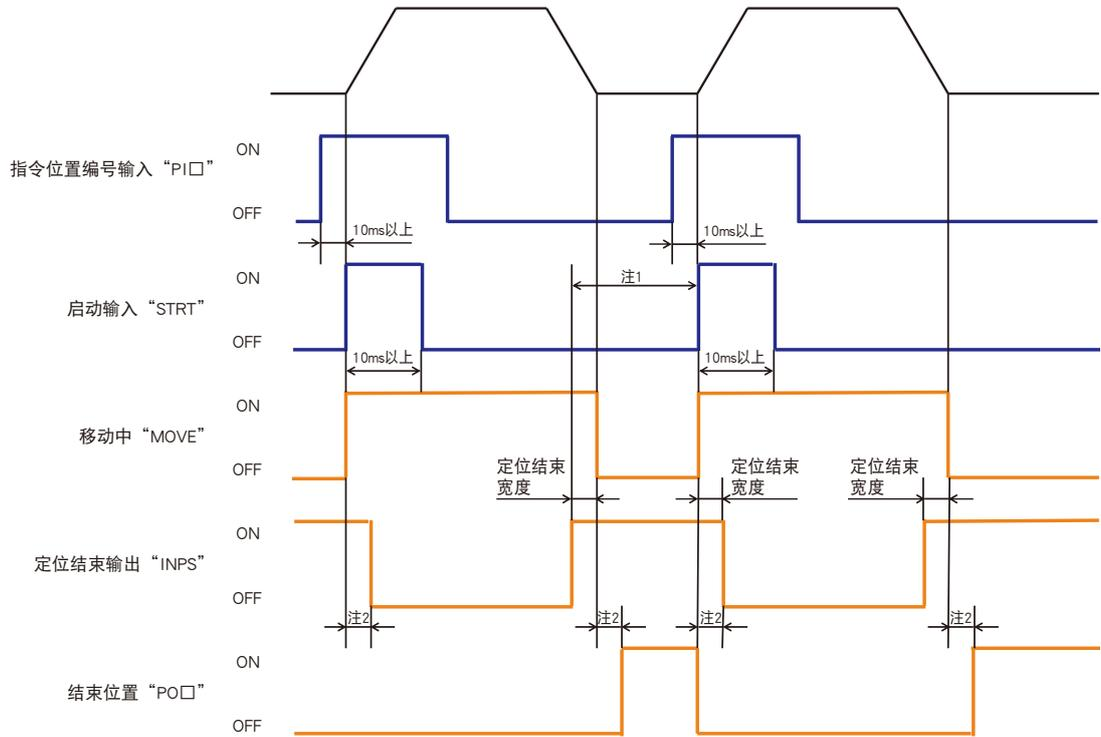
注1 “INPS”变为ON之前输入时，会在“INPS”变为ON之后进行多级变速动作
